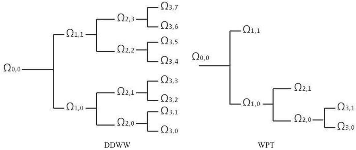
**Fig.4.** Descomposición del vector  $\Omega \in \mathbb{R}^N$  hasta el nivel de descomposición 3. Izquierda: mediante transformada *wavelet packet*. Derecha: mediante descomposición multiresolución. Obsérvese que WPT es una versión generalizada de la DDWT.
