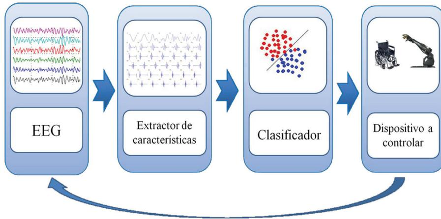
Fig. 1. Diagrama en bloques de una ICC típica.
