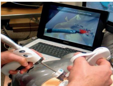
Fig. 1. Entrenador háptico para cirugía [2].
