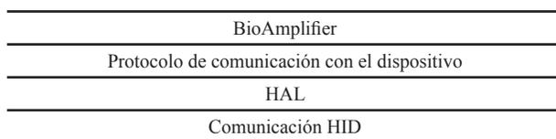
**Fig. 5.** Diagrama con el modelo de capas con el cual se implementó la biblioteca de software para acceder a las funciones del sistema de adquisición.
