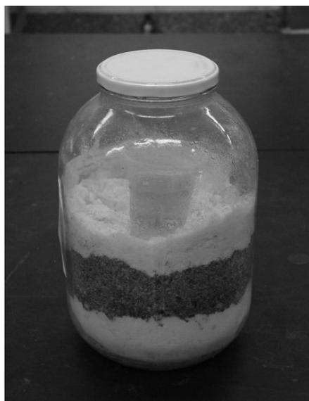
**Figura 1.** Montaje utilizado para determinar la biodegradabilidad del polímero simulando un relleno sanitario
