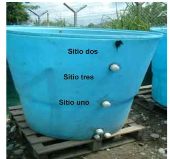
Foto 1. Celda experimental abierta con orificios para muestreo
