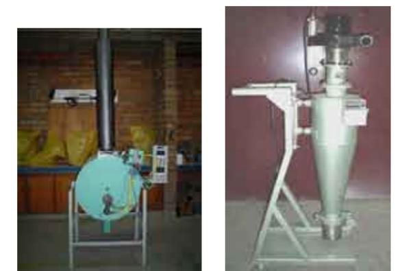
Figura 4. (a) Equipo de pirólisis de cáscara de arroz, (b) Equipo de separación
