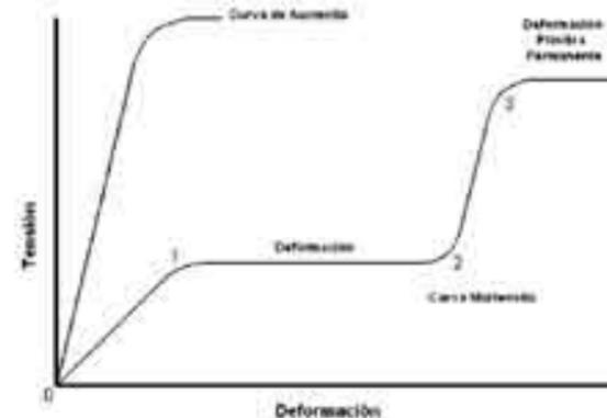
Figura 3. Curva tensión-deformación de fase austenítica y martensítica del nitinol. Adaptación de Mavroidis et al. (2000)
